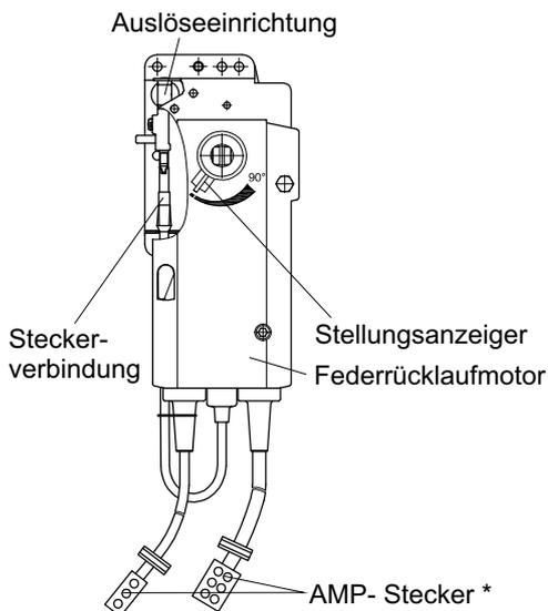
Die Federrücklaufmotore sind in der dargestellten Position an der Brandschutzklappe montiert.
