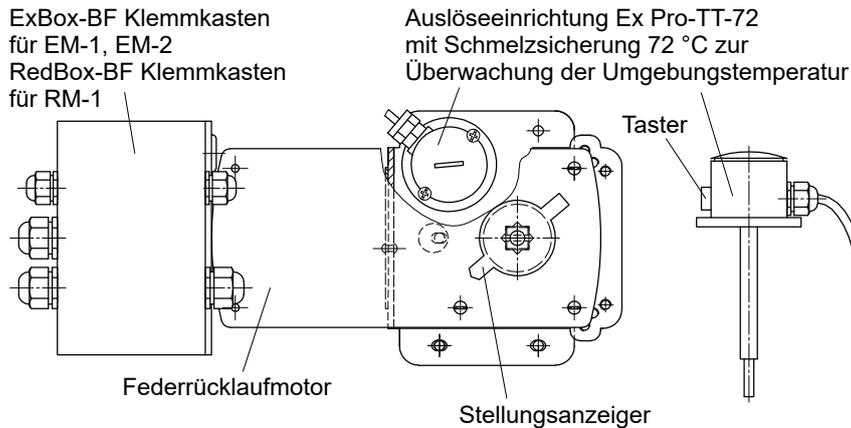
Die Federrücklaufmotore sind in liegender Position an der Brandschutzklappe montiert.
