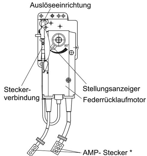
Die Federrücklaufmotore sind in der dargestellten Position an der Brandschutzklappe montiert.
