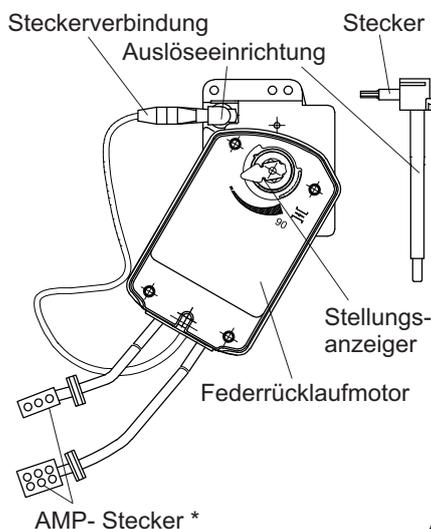
Die Federrücklaufmotore sind in der dargestellten Position an der Brandschutzklappe montiert.
