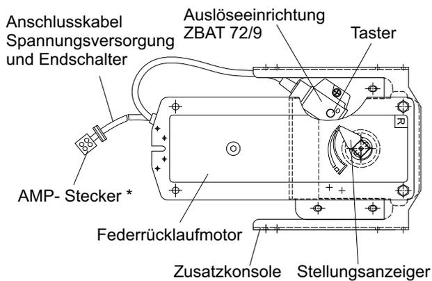
Die Federrücklaufmotore sind in liegender Position an der Brandschutzklappe montiert. Bauseits können sie in eine hängende und in eine stehende Position gedreht werden!
