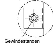
**Brandschutzklappen in Unterdecken** müssen zentrisch in die Öffnungen der Deckenelemente eingebaut werden.
