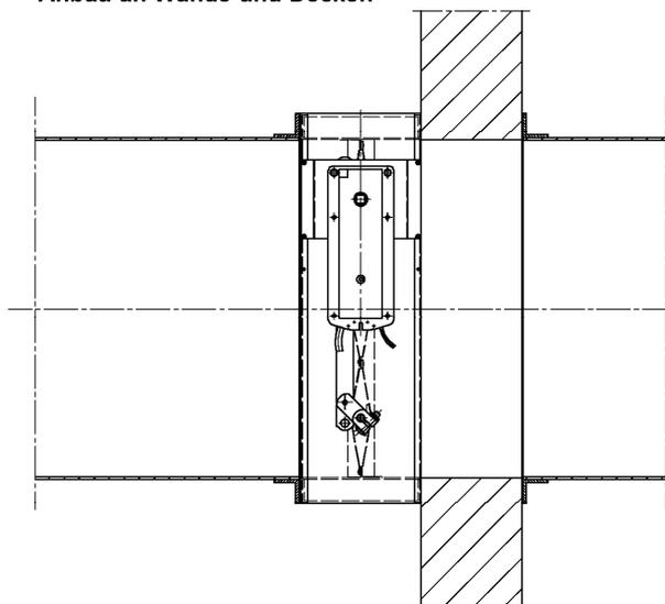
**Einbau in Lüftungsleitungen**
