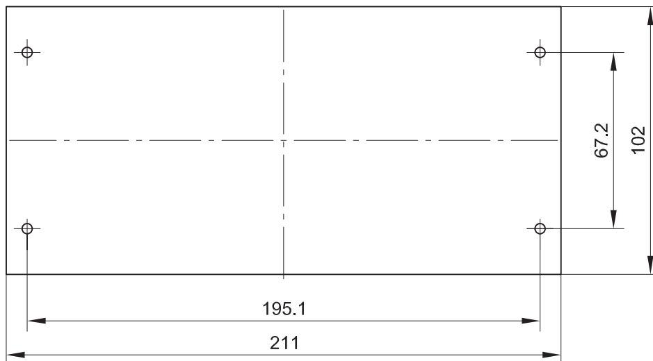
Abb. 07: Bohrplan für Montage BS2-IO-01 ohne Montagelaschen
