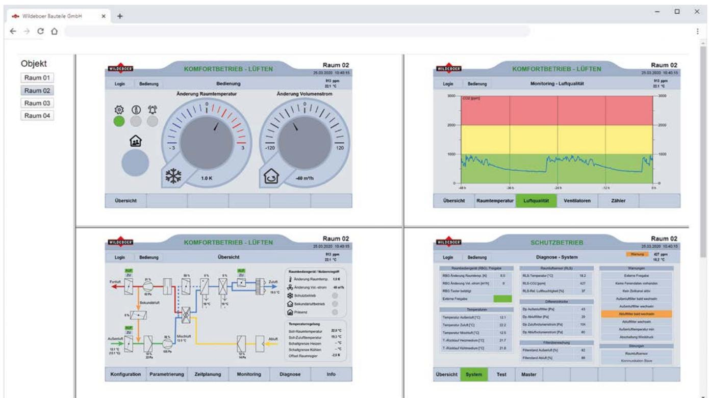
**Beispiel 5:** Zugriff auf Lüftungsgeräte eines Raumes, mehrere unterschiedliche Software-Ansichten.
