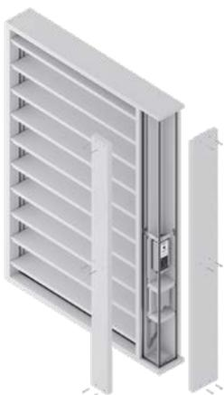
Der Antriebskasten ist je nach Einbausituation für den Zugang von vorne oder seitlich einzurichten. Bauseits können die im Lieferumfang befindlichen Griffe entsprechend platziert werden!
