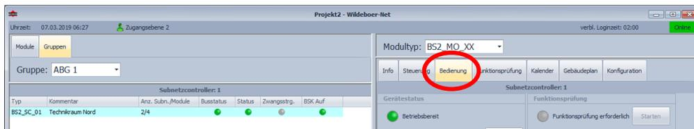
Auf den Bedienungskarten der BS2-MO Motor-Module und der FKKUE-03 Steuereinheiten, die der Arbeitsgruppe zugeordnet sind, werden im Bereich **Funktionsprüfung** eine LED **Ventilator aus** und die Schaltflächen **Ein** und **Aus** angezeigt. Die drei Elemente sind auf den Bedienungskarten nur sichtbar, wenn die ausgewählte(n) Brandschutzklappe(n) einer Arbeitsgruppe zur *Ventilatorabschaltung* zugeordnet ist/sind.
