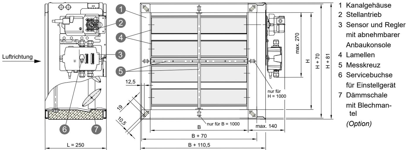
**DKpro Druckregler** sind wartungsfreie, elektronische Regler für konstante und variable Drücke in raumlufttechnischen Anlagen oder zugehörigen Räumen. Sie können in beliebiger Einbaulage in Lüftungsleitungen für Zuluft und Abluft eingebaut und betrieben werden.
