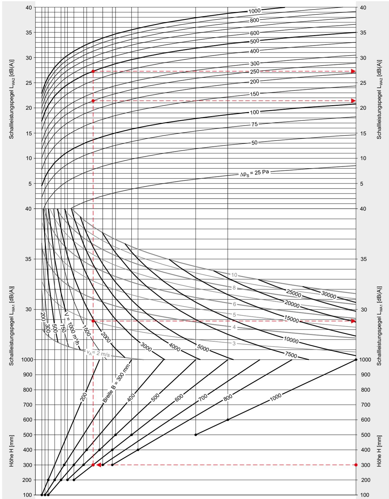
Die Dimensionierung des Schallleistungspegels außerhalb der Anschlussleitung erfolgt im oben dargestellten Nomogramm als Summenpegel  $L_{WA}$ . Oktav-Schallleistungspegel  $L_{W-OKt}$  ergeben sich für jede Größe und für beliebige Betriebspunkte aus der WILDEBOER- Dimensionierungssoftware.
