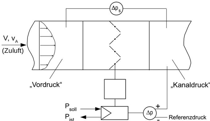
Der Regelvorgang schließt oder öffnet die Lamellen im Gehäuse des Druckreglers mehr oder weniger. Das bewirkt eine Änderung des statischen Druckverlustes  $\Delta p_s$ .
