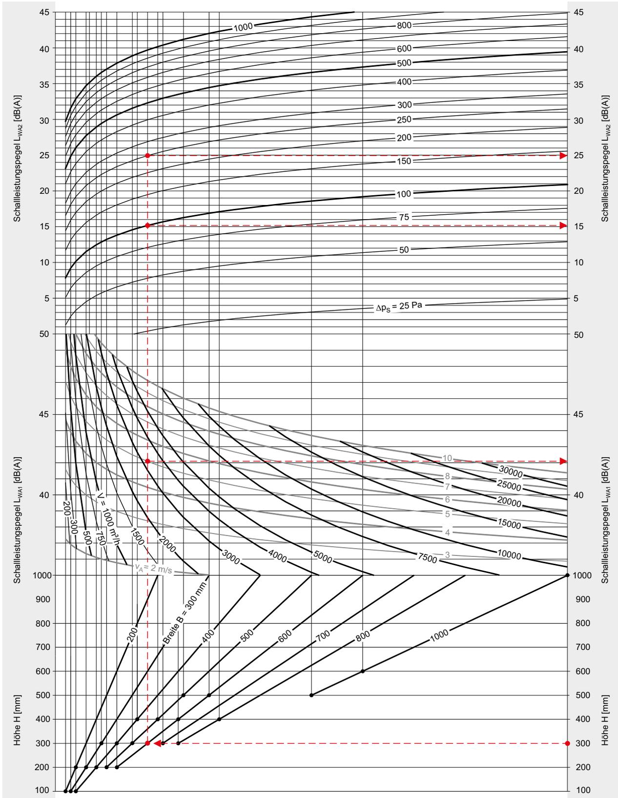
Die Dimensionierung des Schallleistungspegels innerhalb der Anschlussleitung erfolgt im oben dargestellten Nomogramm als Summenpegel  $L_{WA}$ . Oktav-Schallleistungspegel  $L_{W-Okt}$  ergeben sich für jede Größe und für beliebige Betriebspunkte aus der WILDEBOER- Dimensionierungssoftware.
