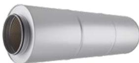
**SRC Rohrschalldämpfer** zur Minderung der Strömungsgeräusche in der angeschlossenen Lüftungsleitung. Packungsdicke: 50 mm Mineralwolle
