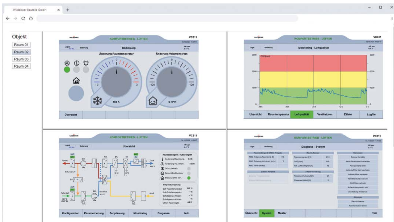
Beispiel 5: Zugriff auf Lüftungsgeräte eines Raumes, mehrere unterschiedliche Software-Ansichten.
