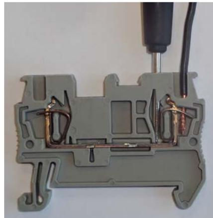
1. Führen Sie beim Öffnen der Klemmen den Schraubendreher leicht schräg in die Klemme ein.
