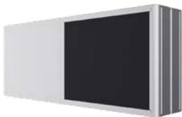
SE-B Breitband-Kulissen bestehen aus separaten Absorptionsflächen, die aus mit Glasseide kaschierten Mineralwolle-Einsätzen bestehen und mit verzinktem Stahlblech umhüllt sind, sowie Resonanzflächen, die jeweils mit Abdeckblechen versehen sind. Diese Flächen sind diagonal zueinander angeordnet.
