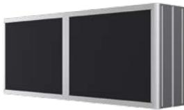
SE-A Absorber-Kulissen bestehen aus separaten Absorptionsflächen, die aus mit Glasseide kaschierten Mineralwolle-Einsätzen bestehen und mit verzinktem Stahlblech umhüllt sind.
